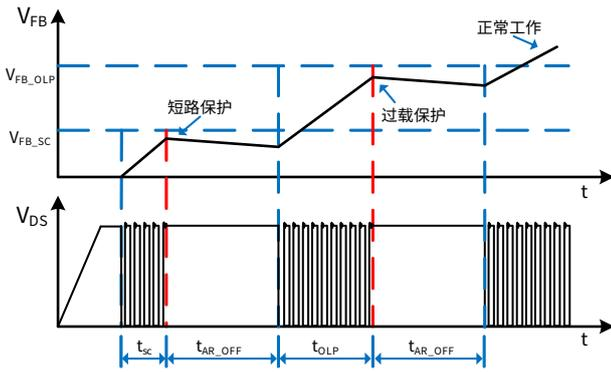
图 9. 短路保护、过载保护工作模式
