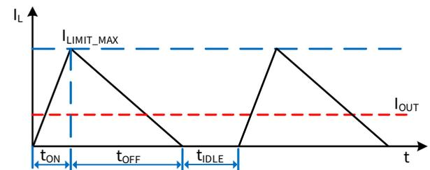
图 11. DCM 模式下的电感电流
