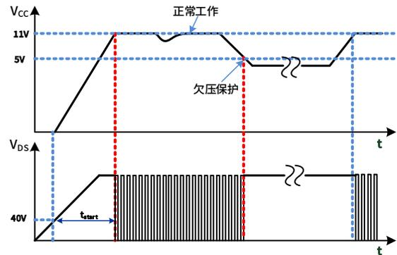
图 5. 高压启动与 VCC 欠压保护时序
