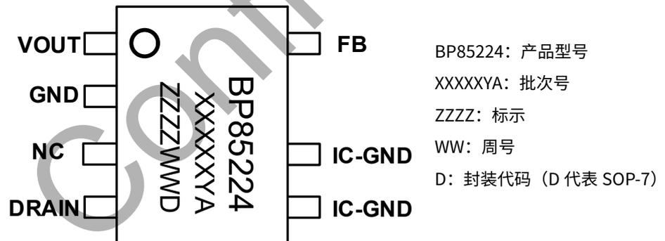
图 3. SOP-7 管脚封装图
