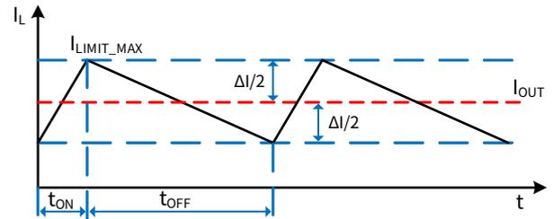
图 10. CCM 模式下的电感电流
