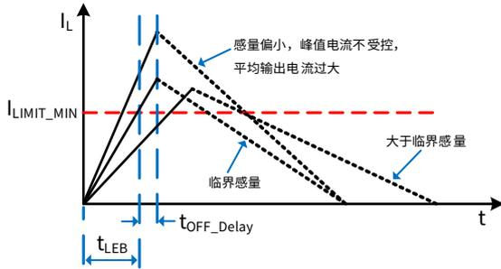
图 12. 空载下的电感电流
