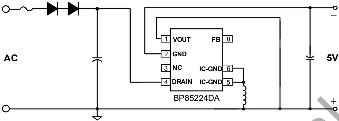
图 2. BP85224DA 典型 Buck-Boost 应用电路
