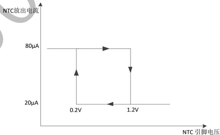
图 19 NTC 电压和放出电流关系
