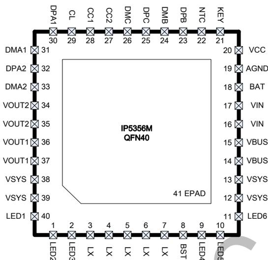
图 2 IP5356M 引脚图
