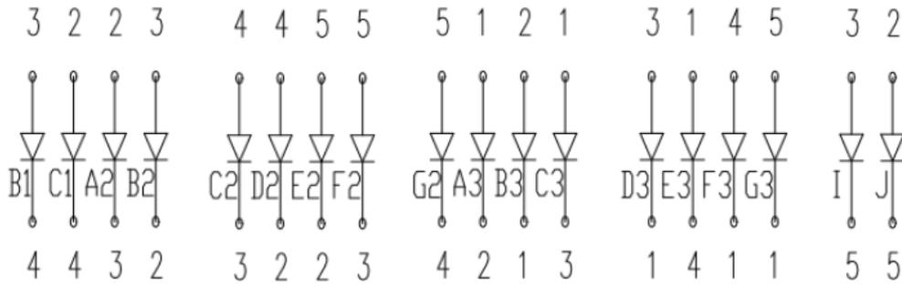
图 16 5 脚 188 型数码管电路图
