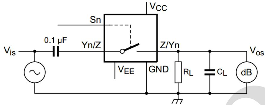
$V_{CC}=4.5V$ ;  $GND=0V$ ;  $V_{EE}=-4.5V$ ;  $R_L=600\Omega$ ;  $R_S=1k\Omega$ .
