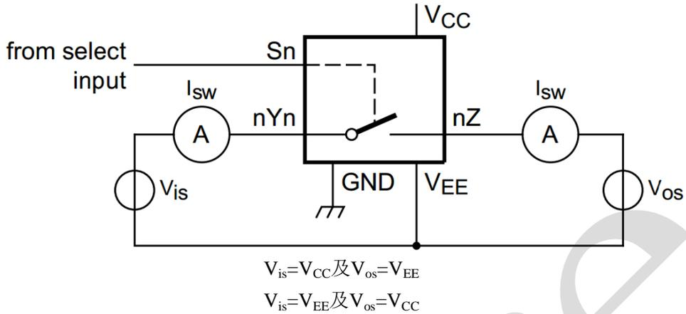
图7、测量关断态电流的测试线路
