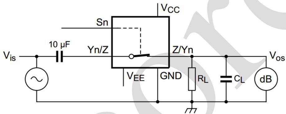
$V_{CC}=4.5V$ ;  $GND=0V$ ;  $V_{EE}=-4.5V$ ;  $R_L=50\Omega$ ;  $R_S=1k\Omega$
