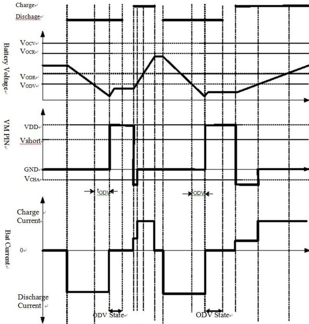
Figure 4. 过放, 充电和正常工作时序图
