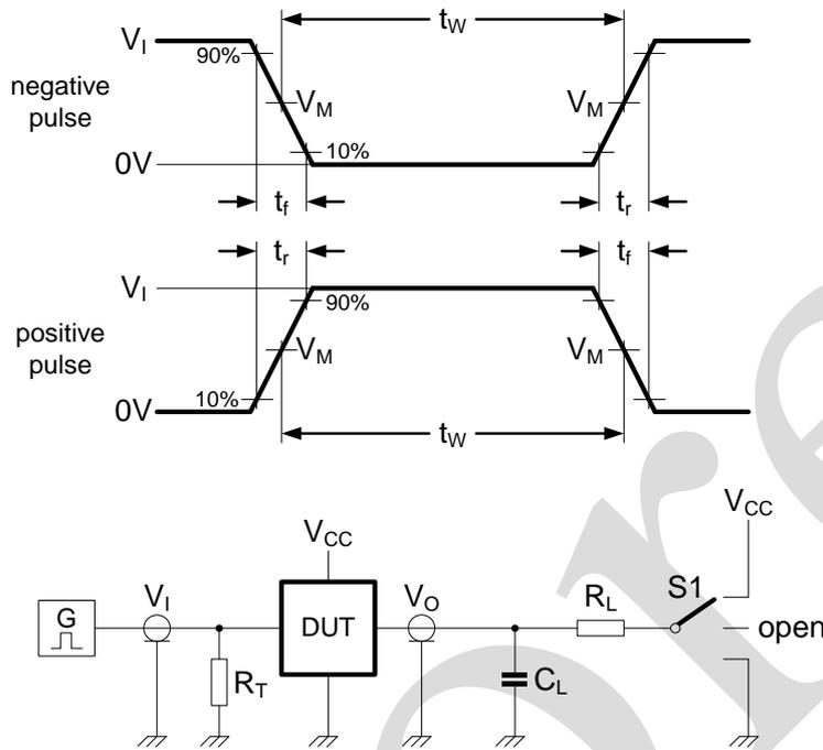
图4 测量开关时间的测试电路
