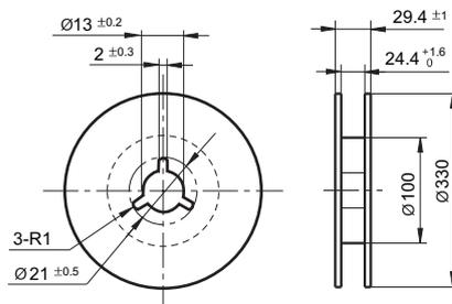
载带外形图 (S型: 标准表面贴装型)
