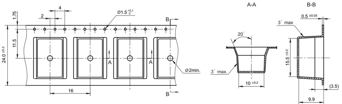
载带外形图 (S1型: 短脚表面贴装型)
