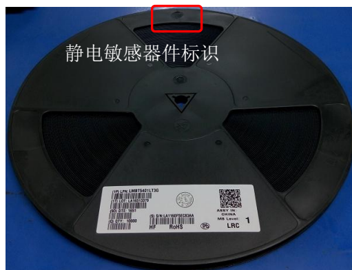
13英寸卷盘标签张贴及QA印章位置
