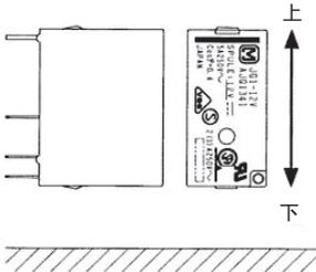
使继电器端子与地面保持平行，将触点端子一侧作为上，将线圈端子一侧作为下进行安装的情况下，执行多次开闭动作，或者在无励磁状态下因震动而造成部件磨损时，可能会发生电压上升，即使施加线圈额定电压也不动作的情况，因此请避免按照上述安装方向进行使用。
